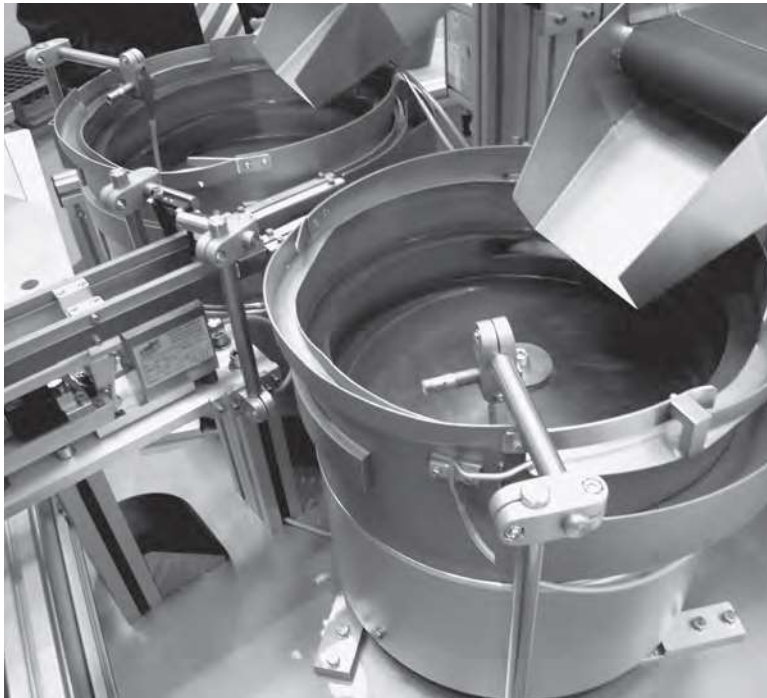
Zuführanlagen mit Werkstückabfragesystemen aus Kreuzklemmverbindern Typ KNK Delivery systems with work piece polling systems of cross clamp type KNK
