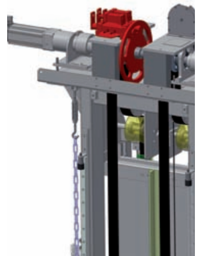
ABS Sicherheitsabsteckung Antriebswelle Lochscheibe ABS safety stacking unit drive shaft indexing disc
