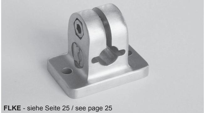
Bei allen Edelstahl Klemmverbindern werden Gleitmo-beschichtete Edelstahlmutter verwendet, um die Reibung zwischen Schraubenkopf und Bauteil zu vermindern. Zusätzlich werden die Edelstahl Klemmverbinder nach und nach mit Entlastungsschlitz für die Bohrungsdurchmesser 12-18 ausgestattet, um die Klemmung zu vereinfachen.
