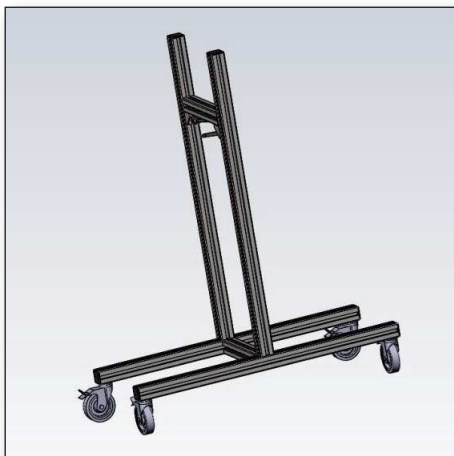
Gestell mit feststellbaren Rollen - Version 2 Rack with lock-type castors - version 2
