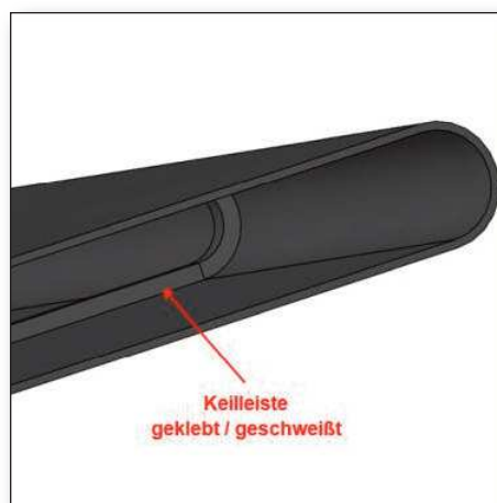
Keilleiste am Fördergurt geklebt / geschweißt Wedge strip on the belt glued / welded
