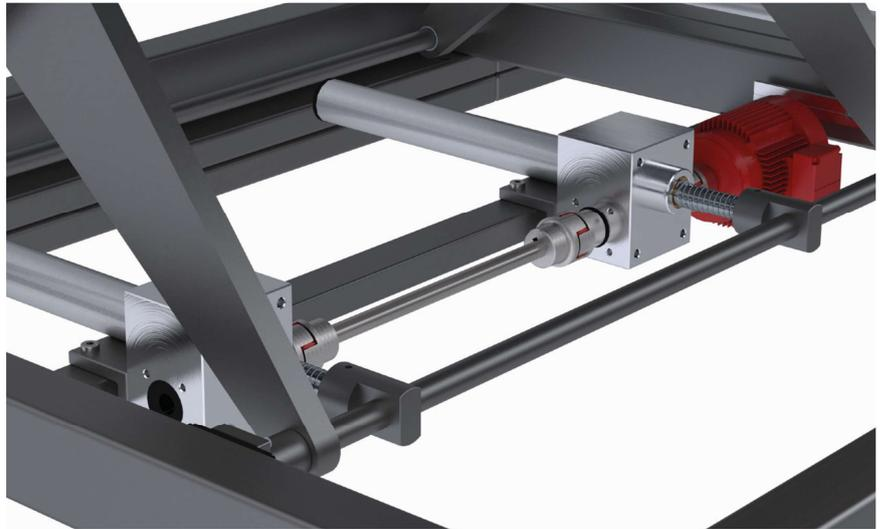
Je zwei über Gelenkwellen verbundene Spindelhubgetriebe der Bauart N, ausgestattet mit Gelenkaugen GA, die direkt an der Gewindespindel angeschraubt sind, realisieren bei dieser Scherenhubanlage die Höhenverstellung. Die Hebelkinematik erzeugt eine Zugspannung auf die Gewindespindeln, dadurch muss die zulässige Knickkraft nicht berücksichtigt werden. Angetrieben wird die Anlage über 2 Drehstrommotoren im Master/Slave Betrieb.
