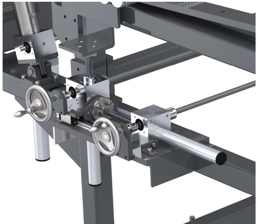
Für die Stangenvereinzelnung einer automatischen Stabzuführung, heben 3 Spindelhubgetriebe der M/J-Serie jeweils eine Stange aus dem Bund in die Zuführung. Um verschiedene Stabdurchmesser verfahren zu können, sind nochmal 3 Hubgetriebe zuständig. Verbunden sind die Hubgetriebe über Gelenkwellen der Bauart RA. Angetrieben werden die langsam übersetzten Getriebe jeweils mit einem Handrad für die Durchmesser-einstellung.
