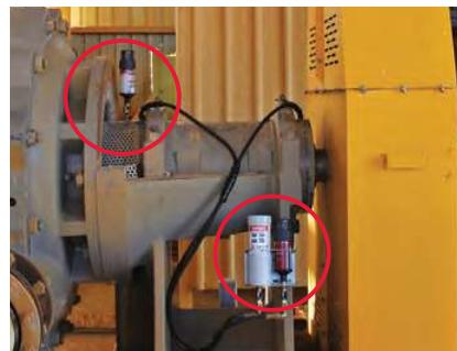
Promazávání ložisek / těsnění čerpadla
