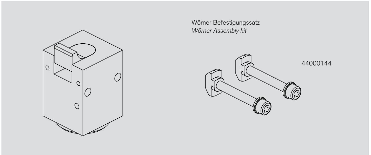
Bei Verwendung von eigenen Befestigungssätzen bitte darauf achten, dass die Festigkeitsklasse min. 8.8 beträgt. Die Einschraubtiefe muss min. 7,5 mm betragen.
