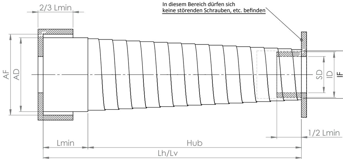
SD = Maximaler Außendurchmesser/ Spindeldurchmesser
