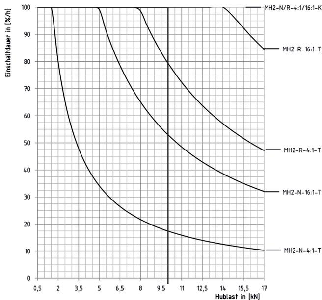
Einschaltdauer-Diagramm bei 1500 1/min und 20° C Umgebungstemperatur.
