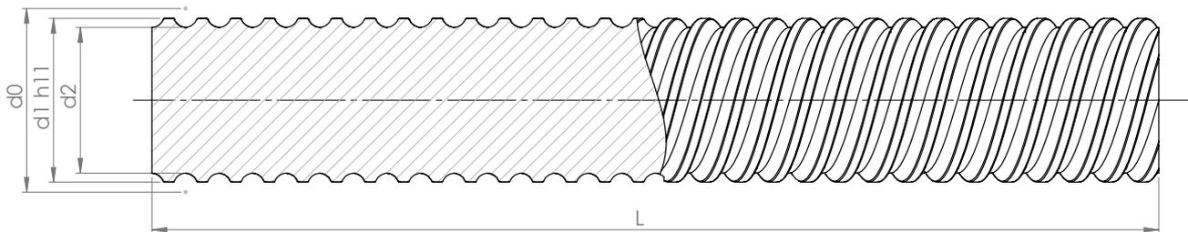
d0= Nenndurchmesser, d1= Außendurchmesser, d2= Kerndurchmesser, L= Spindellänge
