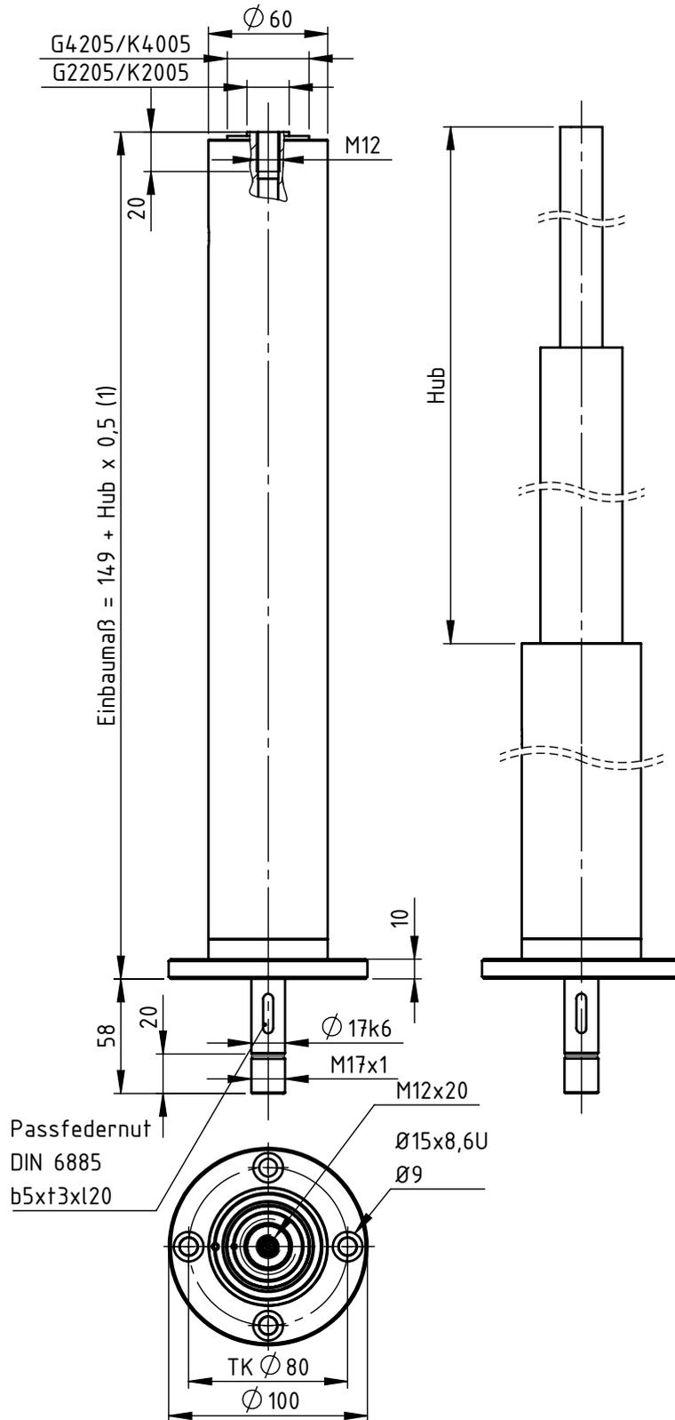
(1) Einbaumaß für Gleitgewindeausführung G mit Sicherheitsfangmutter: 173mm
