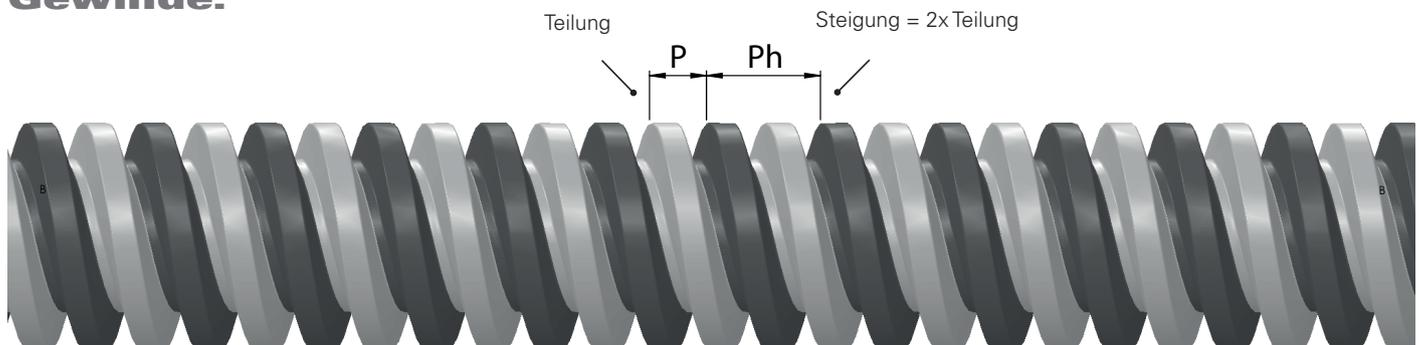
Mehrgängige Gewinde haben das gleiche Profil wie eingängige Gewinde mit der Steigung  $P_h = \text{Teilung} \cdot n$ .
