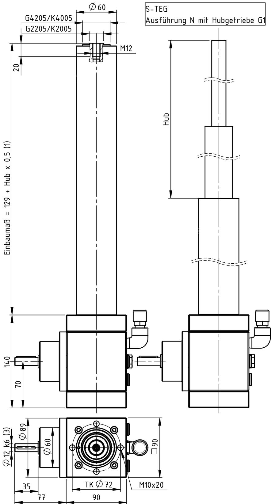
(1) Einbaumaß für Gleitgewindeausführung G mit Sicherheitsfangmutter: 153mm
